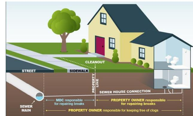
La conexión domiciliaria de alcantarillado es la tubería que transporta las aguas residuales de su vivienda a la red de alcantarillado situada en la calle.
